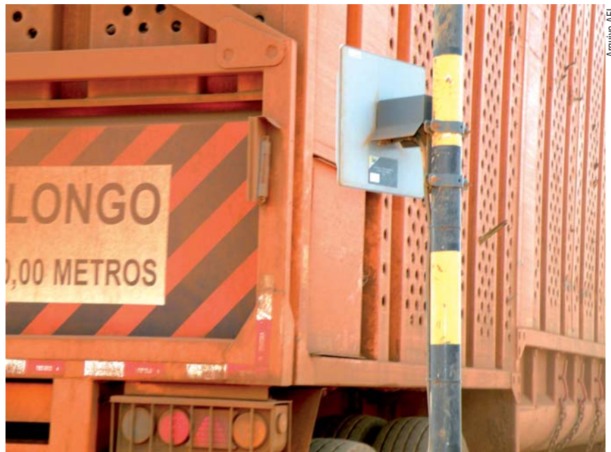
Antena instalada na entrada da balança para captar informações de campo automaticamente
