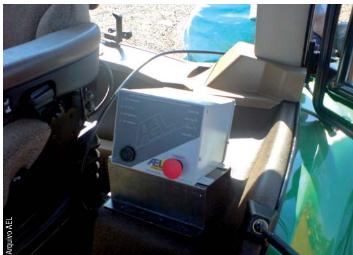
Leitor móvel instalado em trator transbordo para armazenar e transmitir informações de campo
