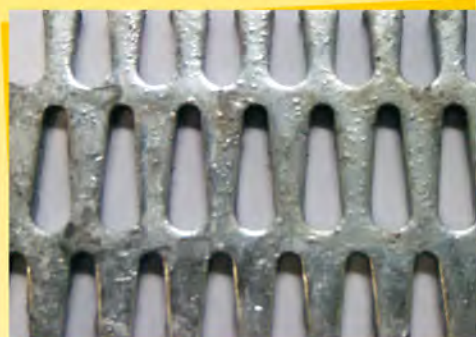
Furos Tipo Gota para Seleção de Bagacilho
